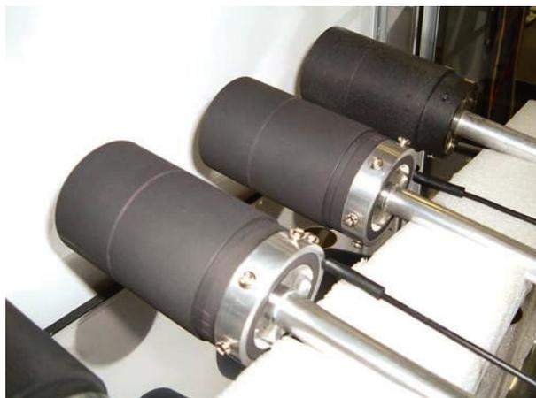
図1 グラファイト壁空洞電離箱
