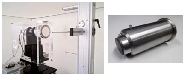
図3 \beta 線照射装置BSS2と外挿電離箱
