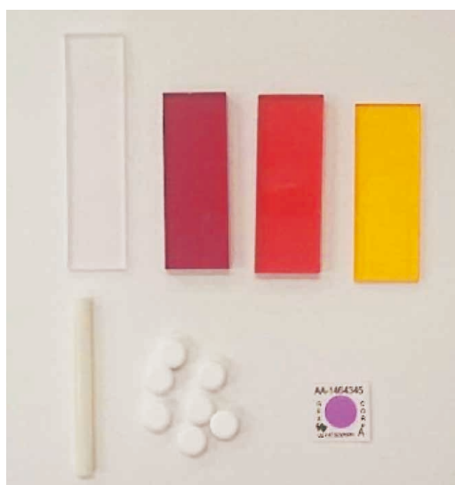
図3 大線量域で使用する線量計の例（上段：4種類の透明/着色PMMA線量計、下段左/中央：2種類のアラニン線量計、下段右：ラジオクロミック（B3）線量計）
