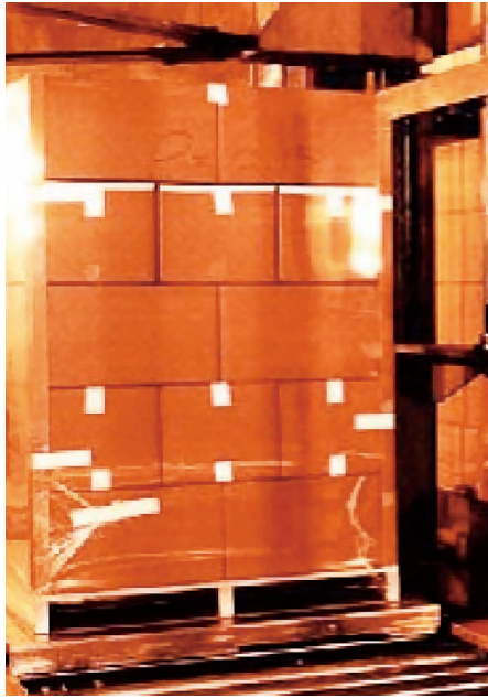
図1 積載した製品入段ボール (1100×1100×1650 mm) のガンマ線照射の例 (対象物を巨大な線源の周囲を周回させることで、連続的に照射する。) 写真提供：ラジエ工業株式会社
