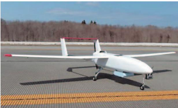
Fig. 8 開発中の小型無人機システムUARMS(機体下部に放射線測定器が設置されている。)
