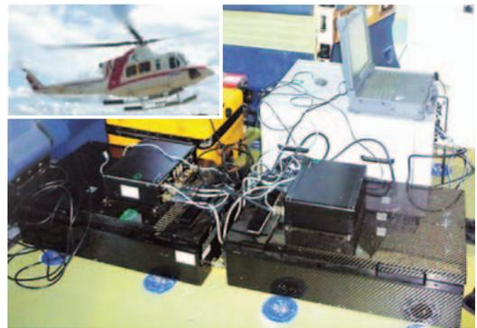
Fig. 1 大型NaI 検出器(手前の2基)、計測機器、バッテリーとそれらを搭載したヘリコプター
