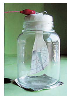
図5 手作りの箔検電器
