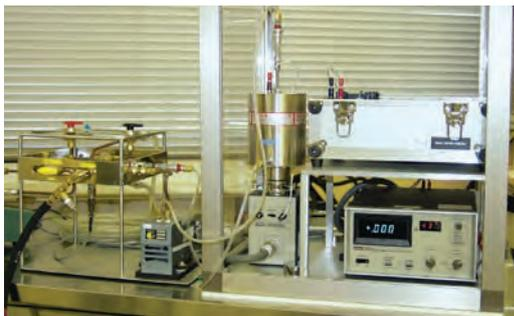
図 1.1 放射性ガスモニタ校正用基準測定器
