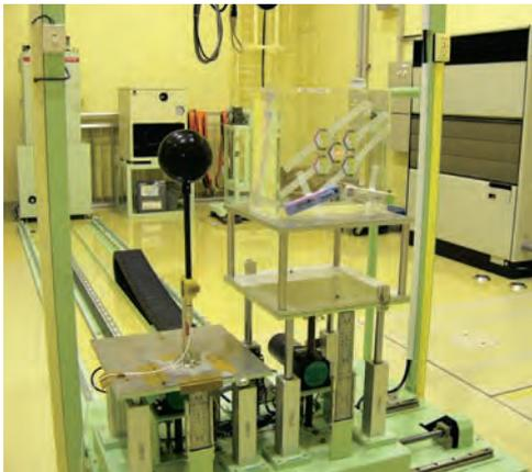
図 2.4 特定二次標準器等（電離箱式照射線量計）の使用例 [個人線量計のX線標準照射]
