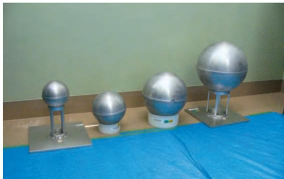
図 2.5 ボナー球型中性子検出器（熱中性子遮蔽用Cdカバー付き）
