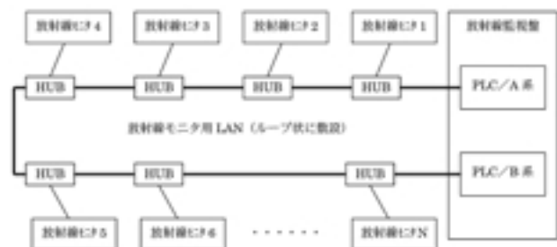
図3 LAN-PLC 方式放射線モニタの概略構成
