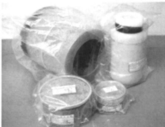
写真 1 様々な標準体積線源の例（材質：気泡ポルトランドセメント）
