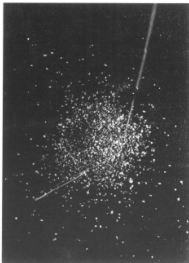
天然放射線のルーツを探る： 花こう岩質の漂砂の中に含まれる1個の放射性漂砂からでる、拡散型霧箱内に見える \alpha 線の飛跡 (撮影：後藤道夫)
