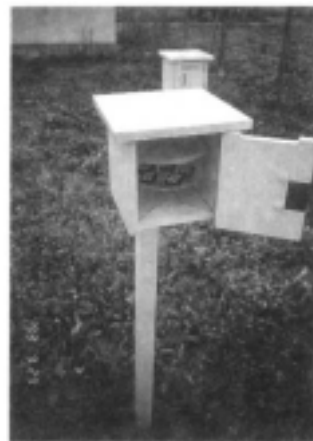
～～「蛍光ガラス線量計のフィールド試験」～～
